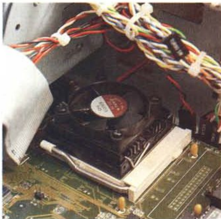
Il processore Intel Pentium 75 MHz è fornito di ventola di raffreddamento.
